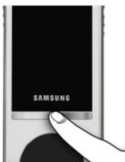
Appuyez sur le bouton [Validation] afin d'allumer le rétro-éclairage du pavé numérique
