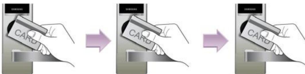
Pour pouvoir enregistrer plusieurs cartes ou badges électroniques, il est nécessaire de les placer sur le lecteur de carte dans les 20 secondes qui suivent l'enregistrement d'une carte ou d'un badge. Si aucune autre carte n'est enregistrée dans les 20 secondes, le processus d'enregistrement se termine automatiquement.
